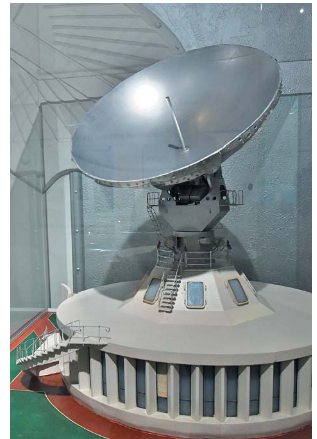
Наземная станция телевизионной космической системы «Орбита», первоначально использовавшая спутники связи «Молния-1»
