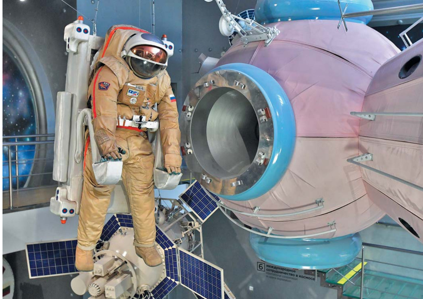
Средство передвижения космонавтов в открытом космосе со скафандром «Орлан-ДМА», опробованное в 1990 году, справа — стыковочный узел базового блока станции «Мир»
