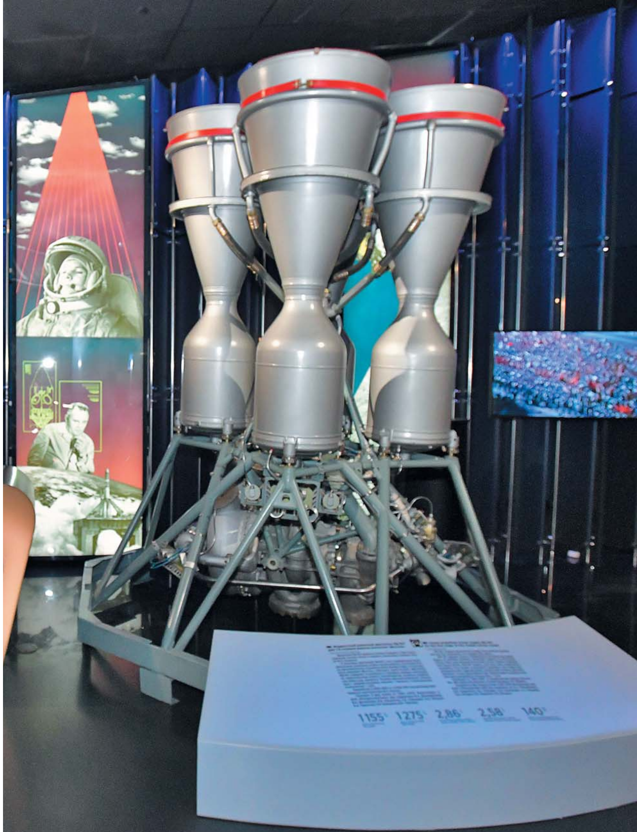
РД-107 — жидкостный ракетный двигатель, созданный для первой в мире межконтинентальной баллистической ракеты Р-7
